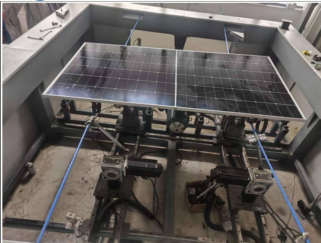
四点不共面动态荷载测试安装照
